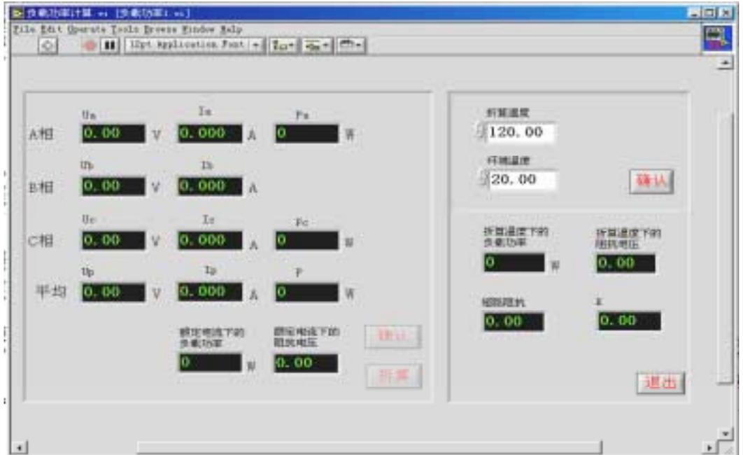
可进行将损耗和阻抗折算到额定条件或直接退出数据处理，可与设计值比较，给出超差提示。由于功率计算公式及温度折算公式比较复杂，我们普遍采用 FORMULA NODE 进行计算。
