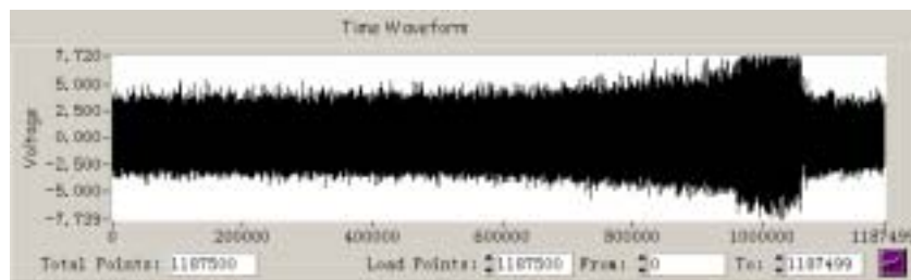
图7 15000转/分转速失速工况第14个传声器所记录声压时间变化历程
