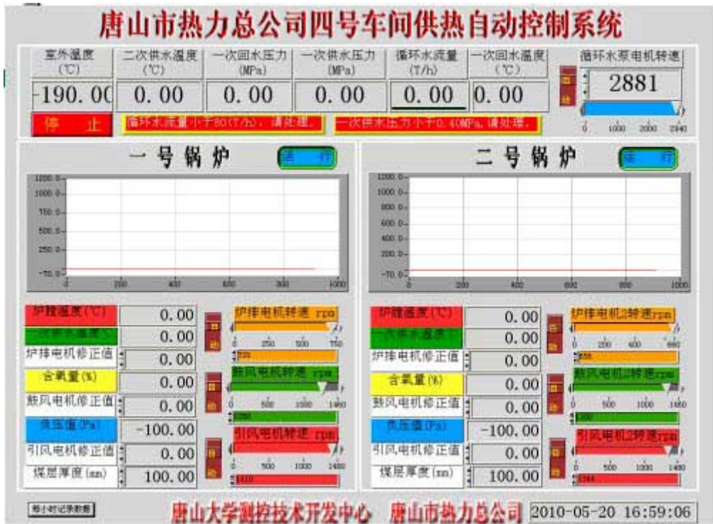
图 4 锅炉供热系统监控界面
