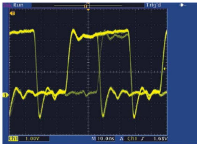
图 1. 示波器详细揭示信号幅度、上升时间及其它模拟特点。
