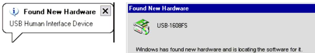
通常情况下如果 USB-1608FS 是第一次和这台计算机连接，计算机显示屏右下角将交替显示多个对话框，计算机操作系统会自动安装 USB-1608FS 所需的驱动程序。请参考 USB-1608FS 安装和使用注意事项。
