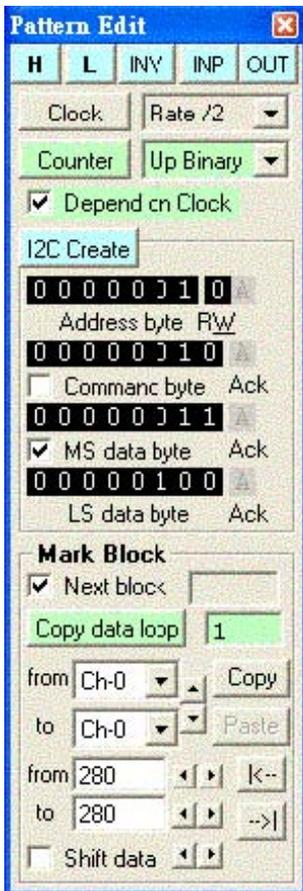
图形发生器同PG-32200逻辑分析仪一起使用，无论是外时钟还是内时钟。这二项功能都用同一时钟源。图形发生器能连续不断的发生图形,直到逻辑分析仪触发，或用户发出命令。
