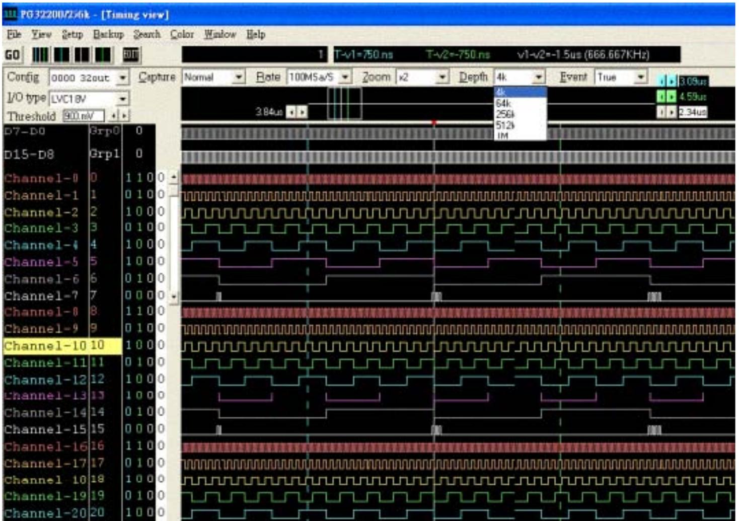
采集的数据以定时脉冲波形显示,每个逻辑通道以它自己的颜色显示,通道名字,滚动条和游标的数值都在主屏幕上显示,主屏幕的窗口能放大也能缩小,显示几个采集数据或整个缓冲区的数据,采集的数据以定时脉冲波形显示在屏幕上。
