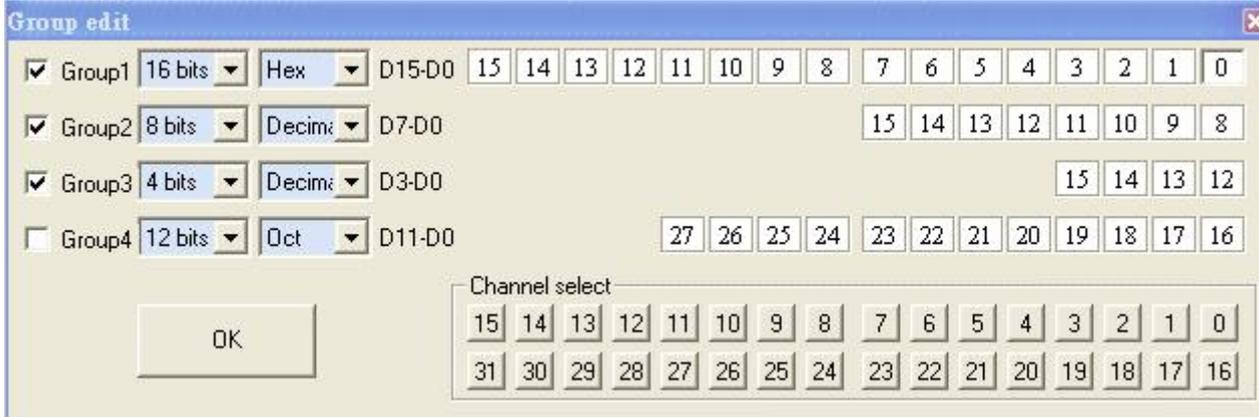
为组通道编辑32个逻辑通道，每组通道支持最大16位字节。每通道能以16进制，10进制，2进制，8进制，ASC码显示。
