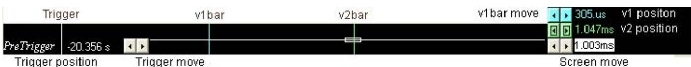
滚动条与选择的波形有关，在显示区内，游标的左右移动都将在水平滚动条区反应。水平滚动条区与逻辑通道，V1游标，V2游标，触发游标显示有关。
